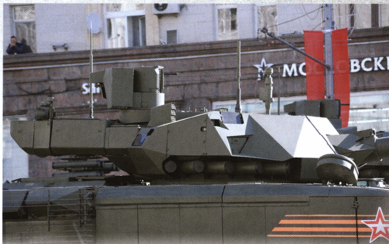
Вид справа на башню танка Т-14. Хорошо видны пусковые установки комплекса активной защиты «Афганит».
