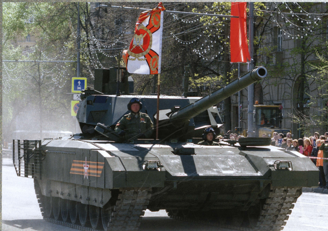
Танк Т-14 «Армата», вид спереди. Хорошо видны рабочие места механика-водителя и командира, Москва, 7 мая 2015 года.
